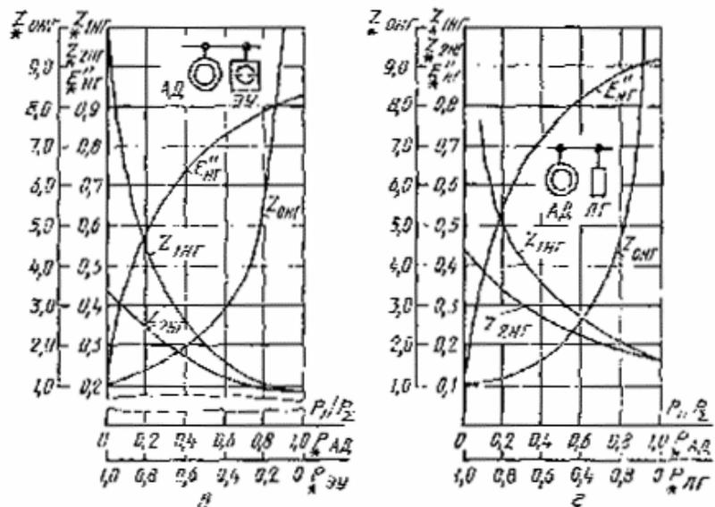
Зависимость параметров комплексной нагрузки  $Z_{1НГ}$ ,  $Z_{2НГ}$ ,  $Z_{0НГ}$ ,  $E''_{НГ}$  от ее состава.
