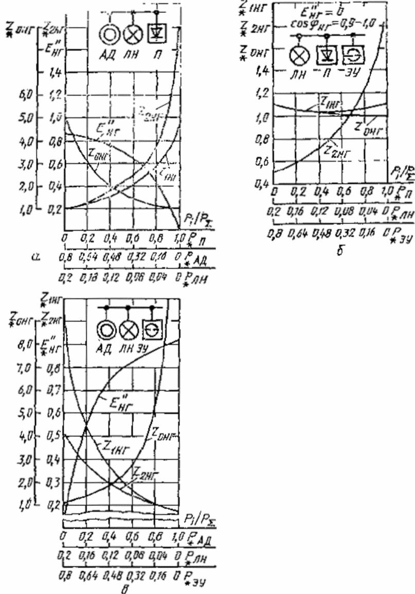
также эквивалентной сверхпереходной ЭДС комплексной нагрузки  $E''_{НГ}$  в относительных единицах при отсутствии других, более полных данных, могут быть определены по кривым, приведенным на черт. 10 и 11 в зависимости от относительного состава потребителей узла нагрузки  $P_i/P_{\Sigma}$ , где  $P_{\Sigma}$  - суммарная номинальная активная мощность нагрузки, кВт;  $P_i$  - установленная мощность  $i$  потребителя нагрузки,
