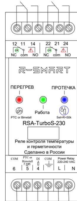
Подключение от 1 до 9 датчиков PTC последовательно
