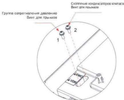
Рисунок 6-2 Варистор(VDR)Конденсатор(EMC)Схема расположения перемычки земли
