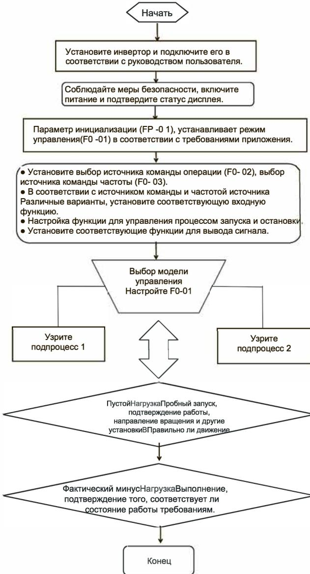
Рисунок 3- 2 Общая блок-схема ввода в эксплуатацию преобразователя частоты
