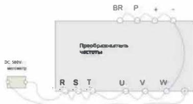
Рисунок 8-1 Схематические круги испытания изоляции основной цепи
