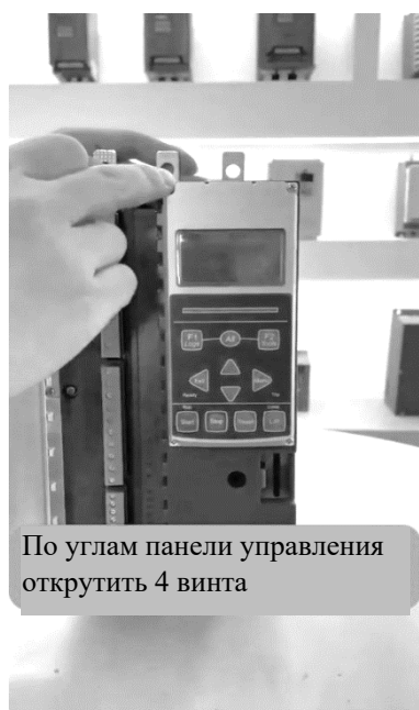
По углам панели управления открутить 4 винта
