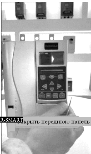
Используя маленькую шлицевую отвертку подденьте рамку вокруг панели управления
