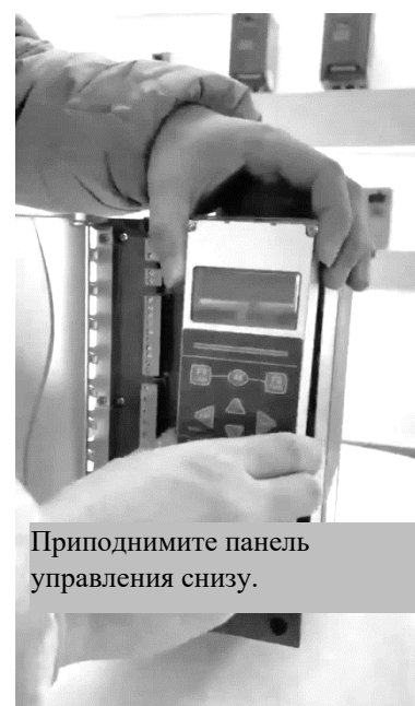
По углам панели управления открутить 4 винта
