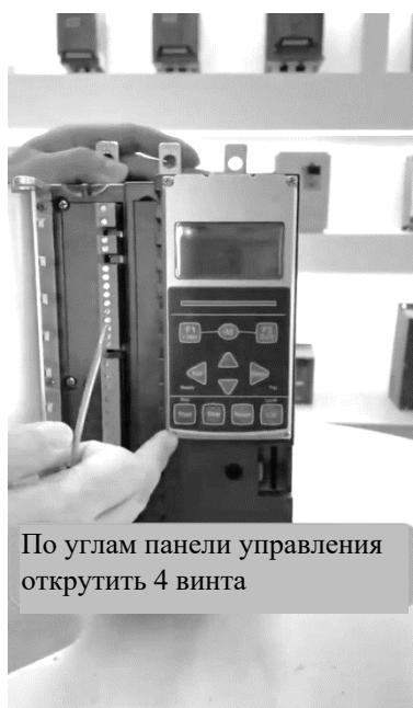
Приподнимите панель управления снизу.
